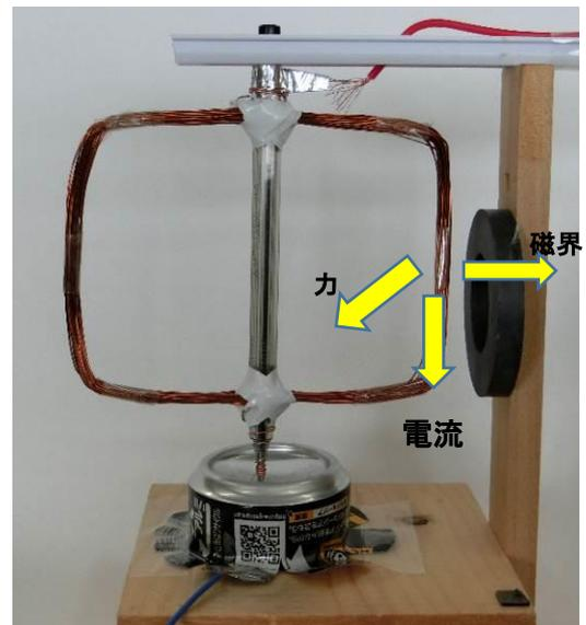
り磁界の強さに差が生じることから説明がつく。磁界が強い方から弱い方に力が生じると考えることができる。磁界と電流の向きが直角な場合、電流が受ける力（電磁力）の向きを表すのがフレミングの左手の法則である。左手の親指、人差し指、中指がそれぞれ直角になるようにしたとき、親指の向きは電流が受ける力、人差し指が磁界の向き、中指が電流の向きとなる。
