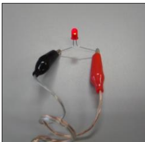
手回し発電機で LED を光らせる 運動エネルギー→光エネルギー
