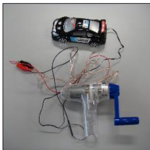
手回し発電機でラジコンを走らせる 運動エネルギー→運動エネルギー
