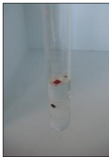
プラスチックの密度の調査 ガムシロップ、水、アセトンの3層をつくり、様々なプラスチックの密度を調べる。
