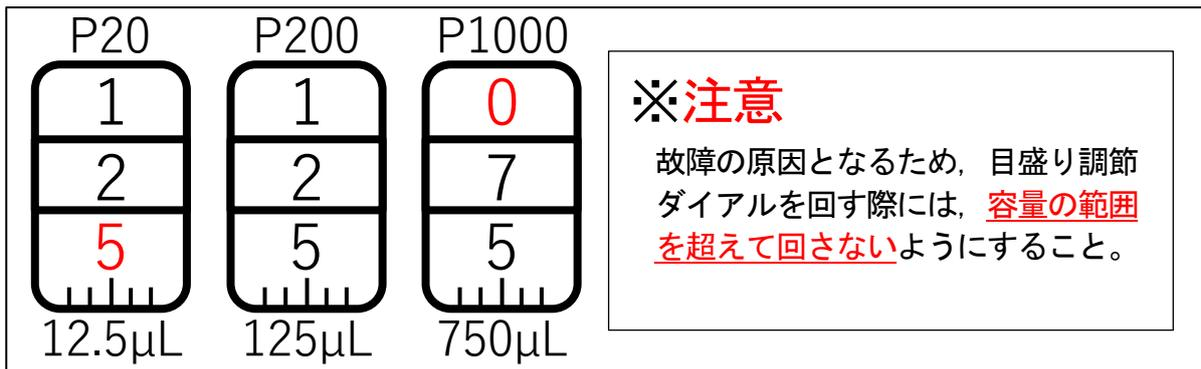
【図 22】マイクロピペットの目盛りの読み方
