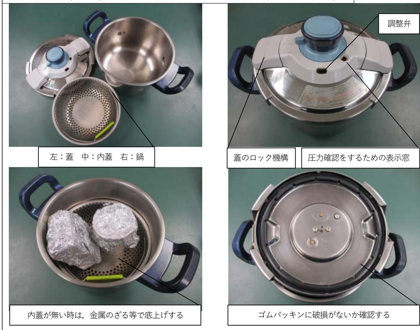
【図8】 圧力鍋をオートクレーブとして用いる際の注意事項
