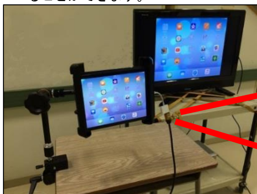
AV アダプターと HDMI ケーブルを接続し、iPad と TV をつなぎ、iPad 画面を TV に出力している様子
