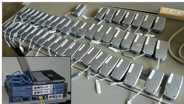
図2.2 携帯電話(NEC製 N900iL)及びSIPサーバ
