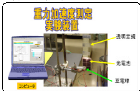
【図24】 重力加速度測定実験装置
