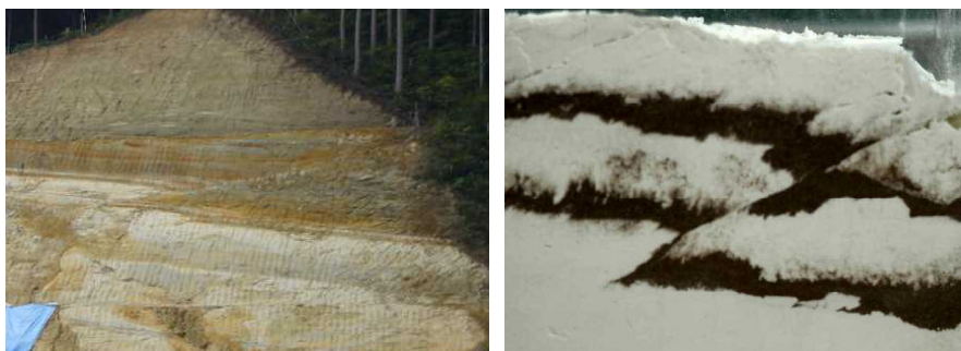
図12 一関市西方本寺地域の活断層（左）と、断層実験による断層（右）。 太平洋プレートの力により、写真左側の奥羽山脈側が地震とともに隆起している。
