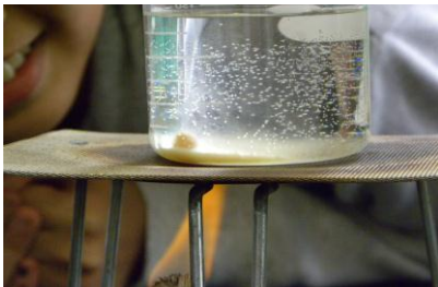
【図 24】 味噌を沈めて熱する対流実験
