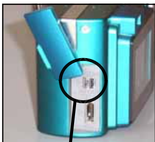
<デジタルカメラ側面AV出力端子>
