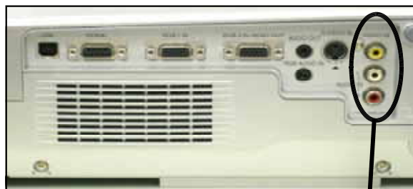
<プロジェクタ側面ビデオ・音声入力端子>
