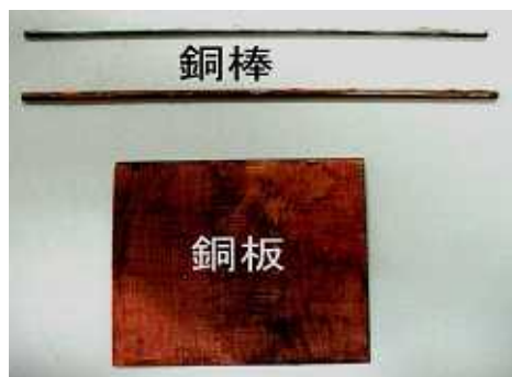
【図5】温度変色銅棒・銅板
