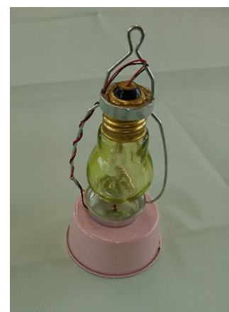
図2 昇圧回路を用いたLEDランタン
