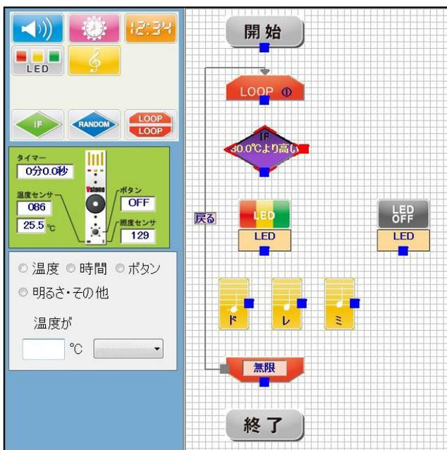
温度センサーの値が 30°Cより高いとき、LED が点灯しドレミの音が鳴る。
