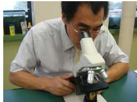
調節ねじを少しずつ回して、対物レンズをプレパラートから遠ざけていき、はっきり見えるところまでとめる。
