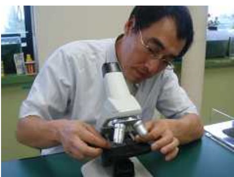
のせ台にプレパラート(観察するものをのせたスライドガラス)を置き、とめ金でとめる。
