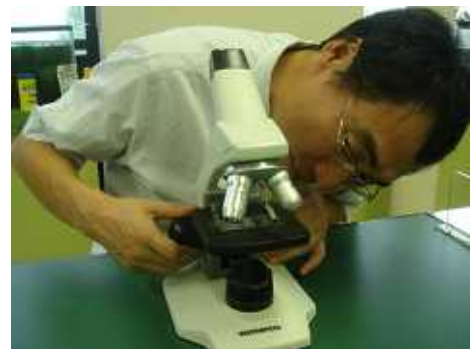
真横から見ながら調節ねじを回して、対物レンズとプレパラートとをできるだけ近づける。 ステージストッパー付きの場合、ハンドルが空転するところまで近付ける。
