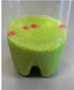
振動により、水とともに表面に浮いてきたBB弾
