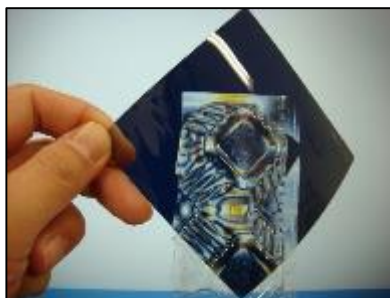
偏光板によるめがねとたまごパックのひずみの観察
