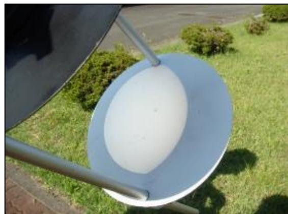
赤い矢印のように投影板の位置を調節することで、太陽の塔映像の大きさを変えることができる。
