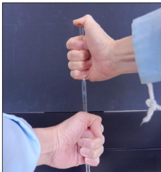
(2) 安全ピペッターを用いたホールピペットの扱い方
