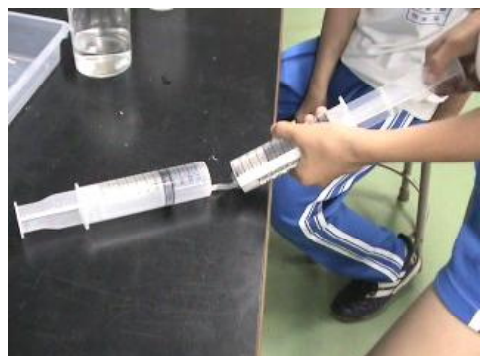
【図21】簡易二酸化炭素測定器を活用した二酸化炭素の測定
