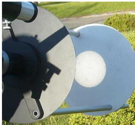
3 太陽の像がずれていく方向が太陽の西である。投影板で観察する場合、実際と左右が逆転していることに注意する。毎日観測させると、黒点が移動していくことがわかり、太陽の自転がわかる。(約10分)
