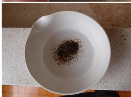
4 乾いた火山灰を薬包紙やシャーレに少量取り、実体顕微鏡のステージにのせて、元の火山灰に含まれている鉱物を観察させる。(約10分)
