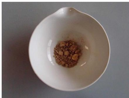
2 親指で蒸発皿の内側にすりつけるようにして粘土分を洗いとらせる。濁った水を捨て、水を加えさせる。
