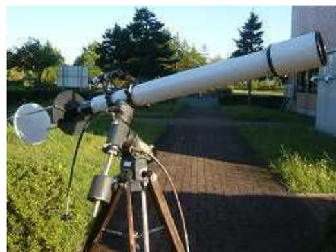
2 太陽の像がはっきりするようにピントを合わせさせる。太陽像が適当な大きさになるように投影板を前後させる。
