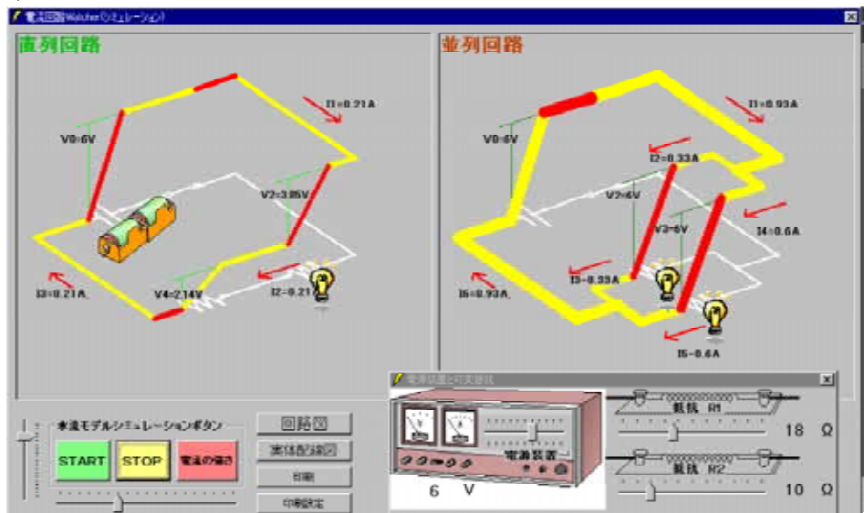
【図11】電圧、抵抗値を自由に変えシミュレーションしているところ
