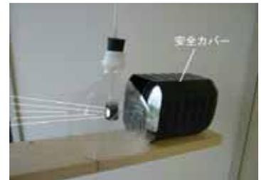
【図43】装着した熱量測定装置
