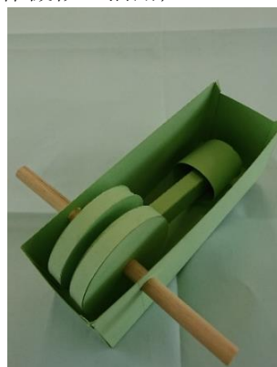
図8 厚紙で作成した往復スライダクランク機構
