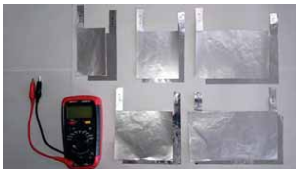
【図 2】 平行板コンデンサーの電気容量を測定する教材
