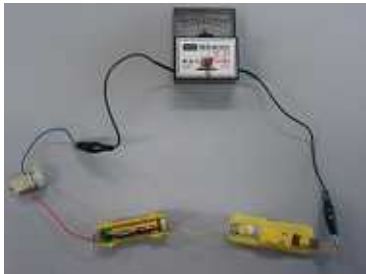
【写真5】(乾電池の向きを反対にしたときの様子)
