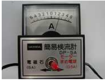
【写真4】(回路をつないだときの検流計の様子)
