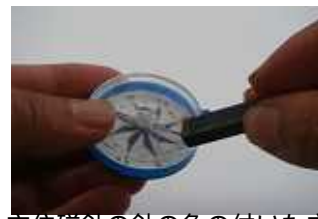
方位磁針の針の色の付いた方に、磁石のS極を近づけ、針の先に向かって、動かす。
