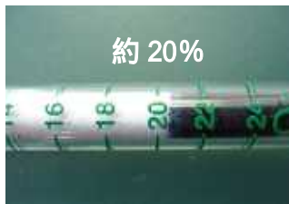
【手順 後の気体検知管 左：酸素，右：二酸化炭素】
