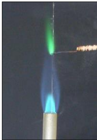
パイルシュタイン反応 銅線にプラスチックをつけ、炎色反応を見る。
