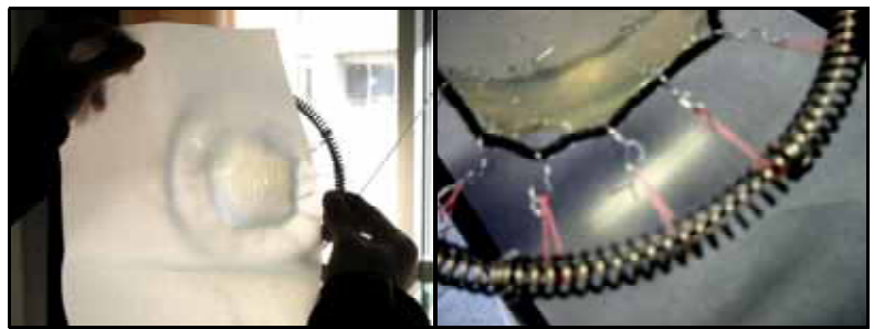
【図9】遠近調節モデルを用いた結像実験(左:風景 右:蛍光灯の光)
