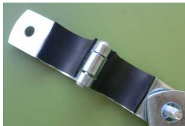
【図 -16】支持部分の補強
