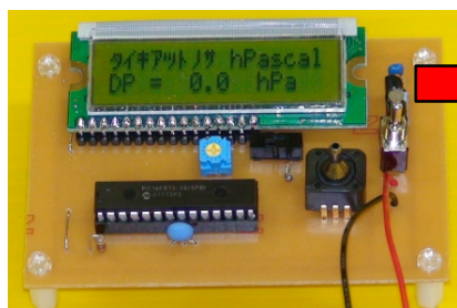
No5 「ボウリング球浮上実験装置での圧力差の測定」
