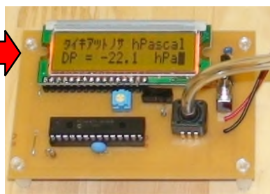
No5 「ボウリング球浮上実験装置での圧力差の測定」
