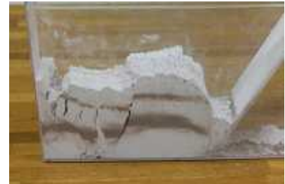
図10 正断層の形成
