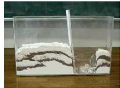
図4 逆断層の形成
