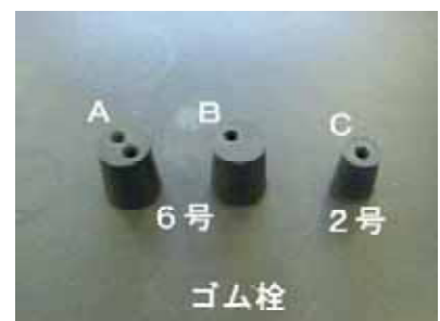
写真4 ゴム栓の加工
