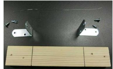
図 1 電熱線装置の材料
